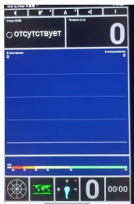
Рис. 6. На планшете отсутствует встроенный приемник GNSS
