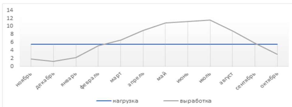
Рис. 8. График среднего объёма планируемой выработки электроэнергии солнечными панелями в Перми график планируемой нагрузки по месяцам
