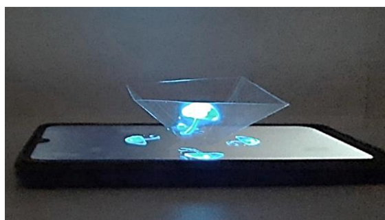
Рис. 8. Готовый проектор для вывода голограмм
