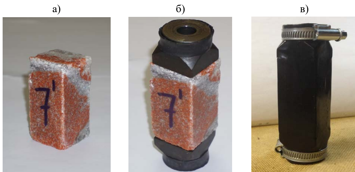
Рис. 4.9. Подготовка образца к испытанию: а – исследуемый образец; б – фиксация торцевых оправок на образце; в – герметизация образца с помощью термоусадочной трубки
