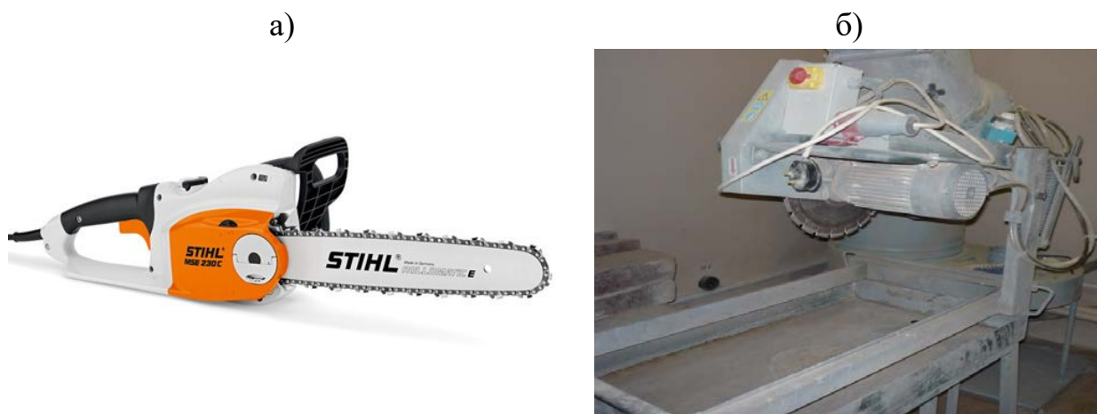
Рис. 2.1. Оборудование для изготовления образцов: а – цепная электропила Stihl MSE 230С; б – алмазный отрезной станок SC-TECHNOLOGIE AG
