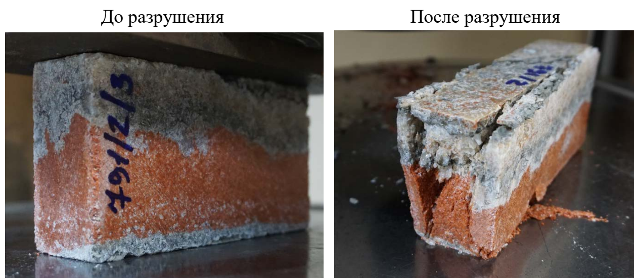
Рис. 2.8. Характер разрушения сильвинитового образца высотой 70 мм и длиной 140 мм (блок 791)
