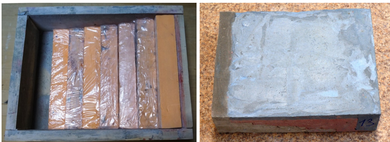
Рис. 3.1. Разборная деревянная форма размером 400x300x100 мм с извлекаемыми пластиковыми вставками (а) и полученный залитый блок (б)
