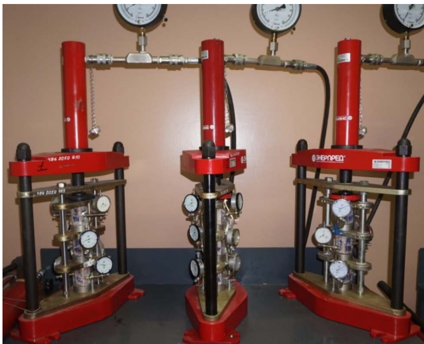
Рис. 4.4. Установки для проведения испытаний на ползучесть при одноосном нагружении
