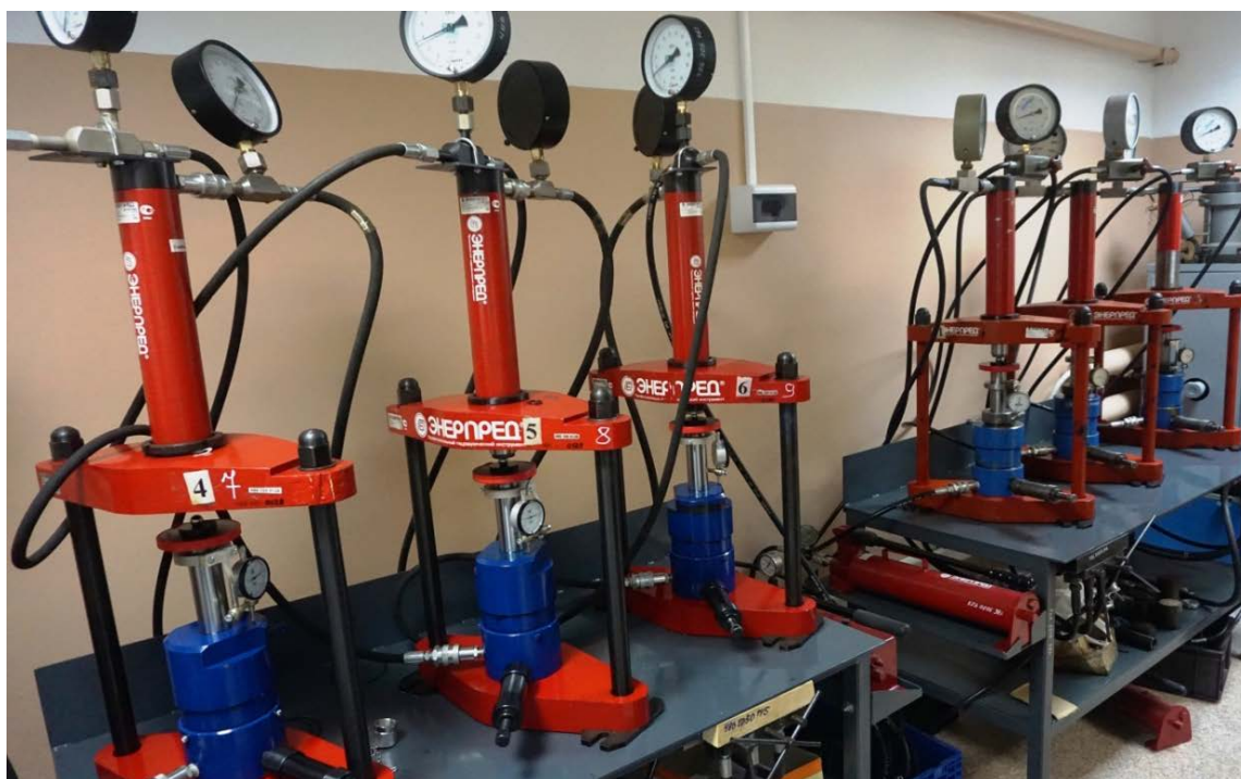
Рис. 4.7. Установки для проведения испытаний на ползучесть при объемном нагружении
