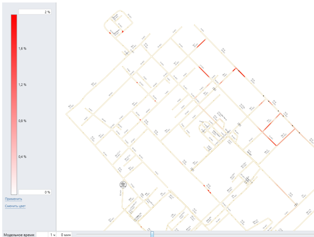
Рисунок 3.11 — Результат моделирования распространения газовых примесей в АК «АэроСеть» без учета продольной диффузии
