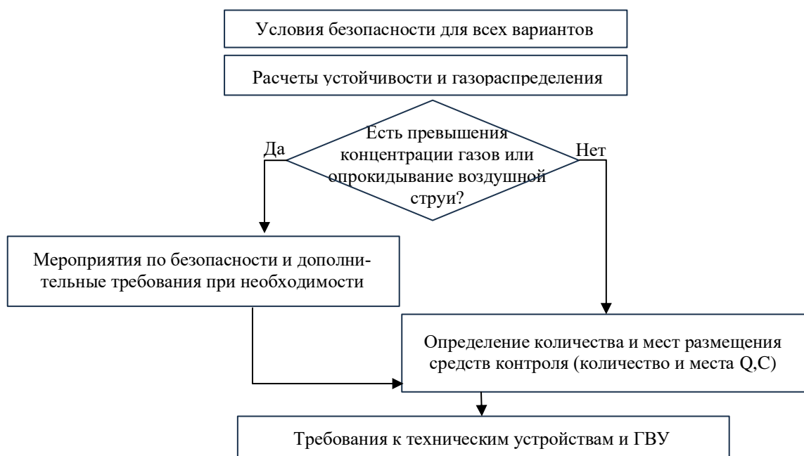
Рисунок 5.9 — Обеспечение безопасности рециркуляционного проветривания
