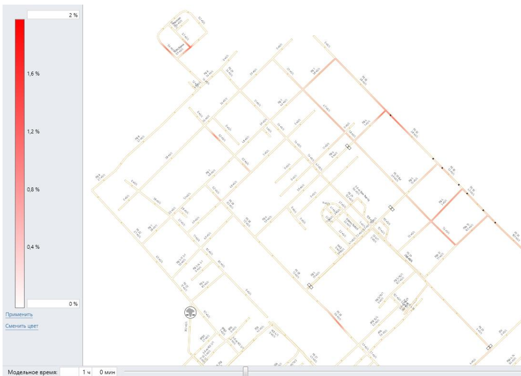
Рисунок 3.12 — Результат моделирования распространения газовых примесей в АК «АэроСеть» с учетом продольной диффузии
