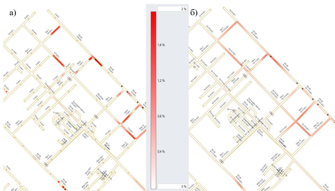
Рисунок 8 — Результат моделирования распространения газовых примесей в АК «АэроСеть» без учета ( а ) и с учетом ( б ) продольной диффузии через 60 минут после начала расчета
