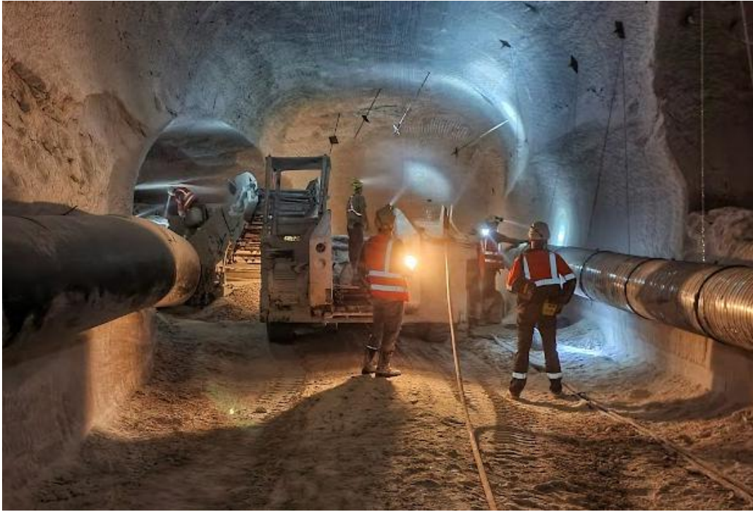
Рисунок 2.12 — Исследуемая выработка с организацией системы вентиляции
