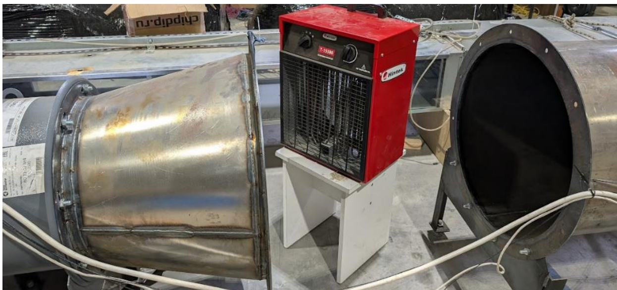
Рисунок 5.11 – Источник нагрева (электрический калорифер) перед блоком испарителя и выходная труба с нагретым воздухом из блока конденсатора
