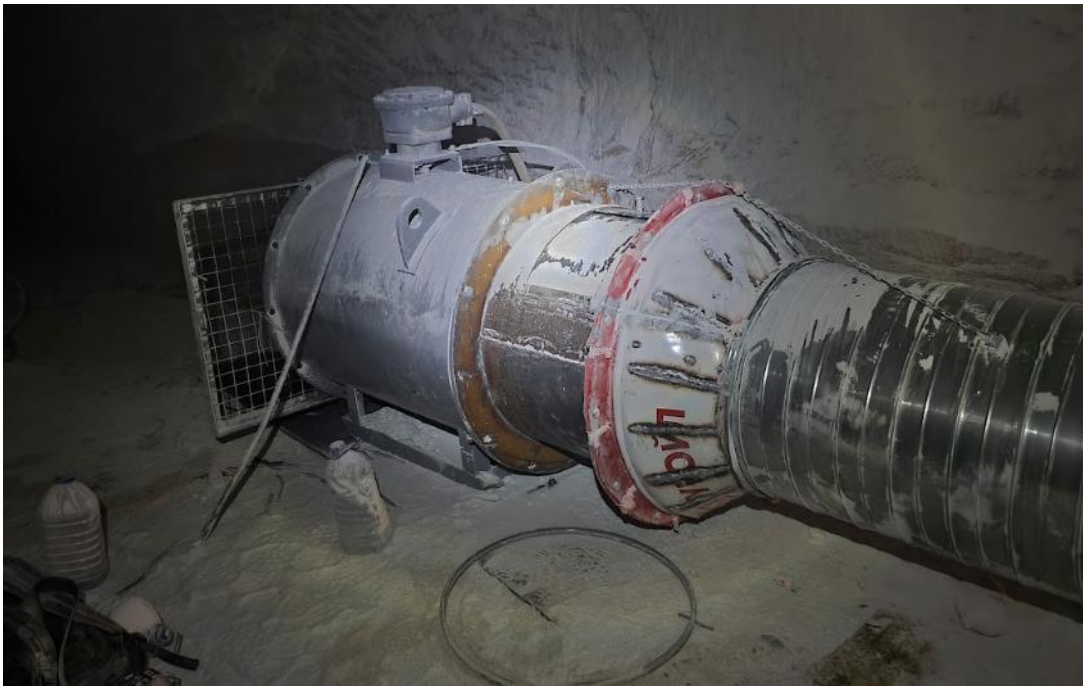
Рисунок 2.13 — Всасывающий вентилятор FBD-7.5 для проветривания исследуемой выработки
