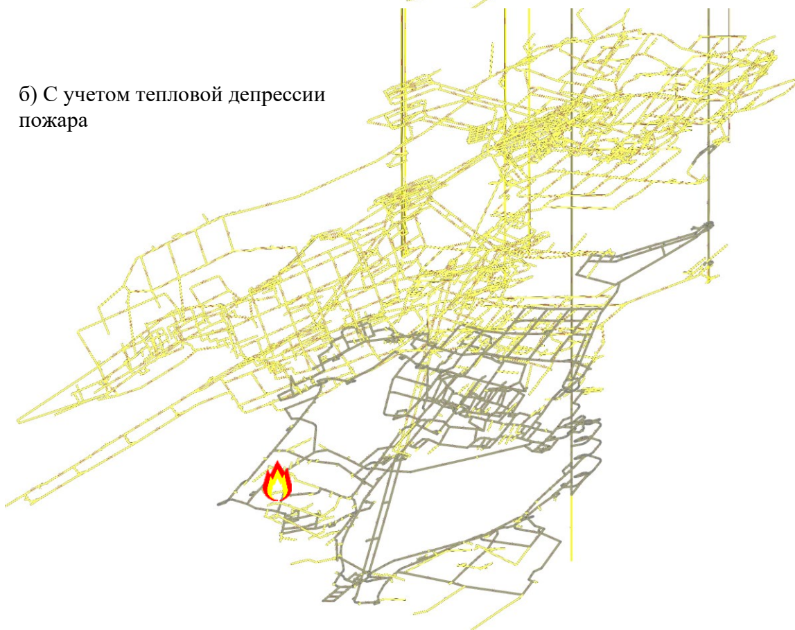
Рисунок 5.8 – Распространение продуктов горения по горным выработкам рудника «Интернациональный» с учетом тепловой депрессии пожара (б) и без учета тепловыделения (а)
