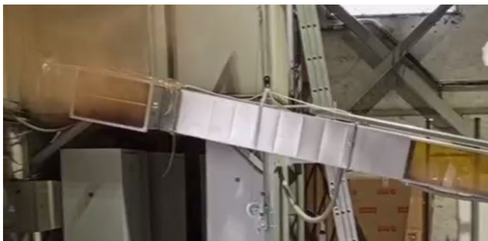
Рисунок 4.12 — Воздушный поток на выходе из вентиляционного отверстия 1 во время эксперимента 1 (красный дым)
