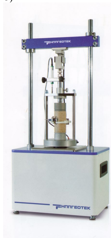
Рисунок 2.3 — Измерительная система АСИС (а) и устройство осевого нагружения (б)
