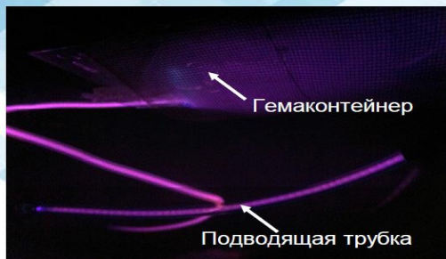
Плазменная обработка внутренней поверхности мешка для сбора и хранения компонент крови
