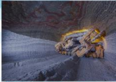
Движение комбайнового комплекса с установленной системой навигации по выработке калийного рудника
